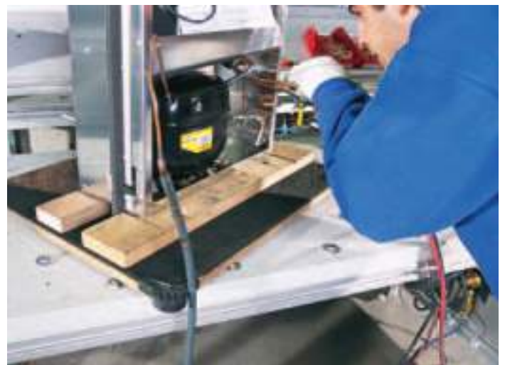
Sistema di montaggio manuale per la produzione di frigoriferi di fino a 75 kg di peso e a 2 m di altezza Sistema de montaje manual para la producción de equipos de refrigeración de hasta 75 kg de peso y 2 m de altura Sistema de montagem manual para a produção de refrigeradores com um peso de até 75 kg e altura de 2 m PfannenberGmbH, Hamburg, D Made by Handke Industrietechnik, Hamburg, D
