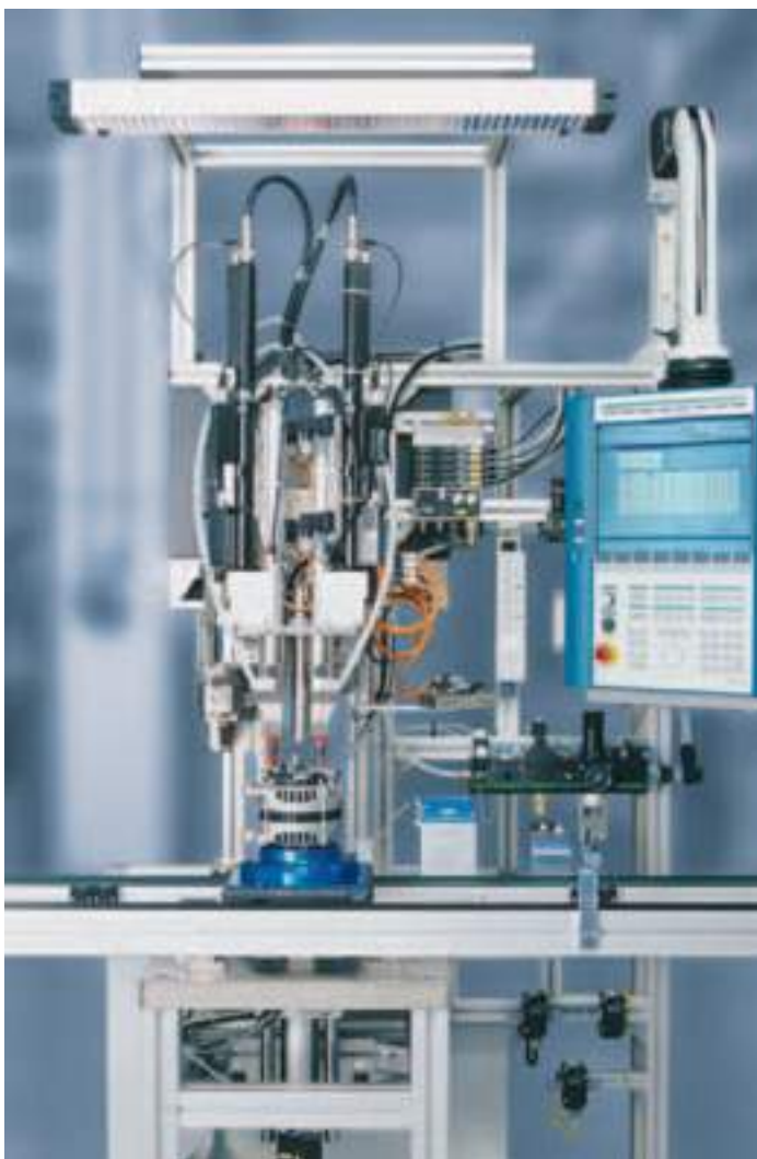
▲ Stazione di avvitamento per la produzione di generatori Estación de atornillado para la producción de generadores Estação de parafusamento para a produção de geradores Robert Bosch GmbH, Stuttgart, D
