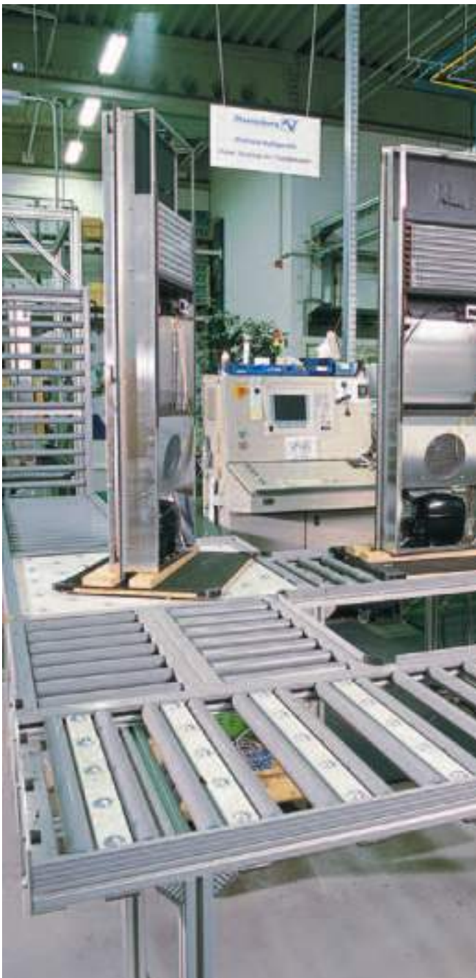
Sistema di montaggio manuale per la produzione di frigoriferi di fino a 75 kg di peso e a 2 m di altezza Sistema de montaje manual para la producción de equipos de refrigeración de hasta 75 kg de peso y 2 m de altura Sistema de montagem manual para a produção de refrigeradores com um peso de até 75 kg e altura de 2 m PfannenberGmbH, Hamburg, D Made by Handke Industrietechnik, Hamburg, D
