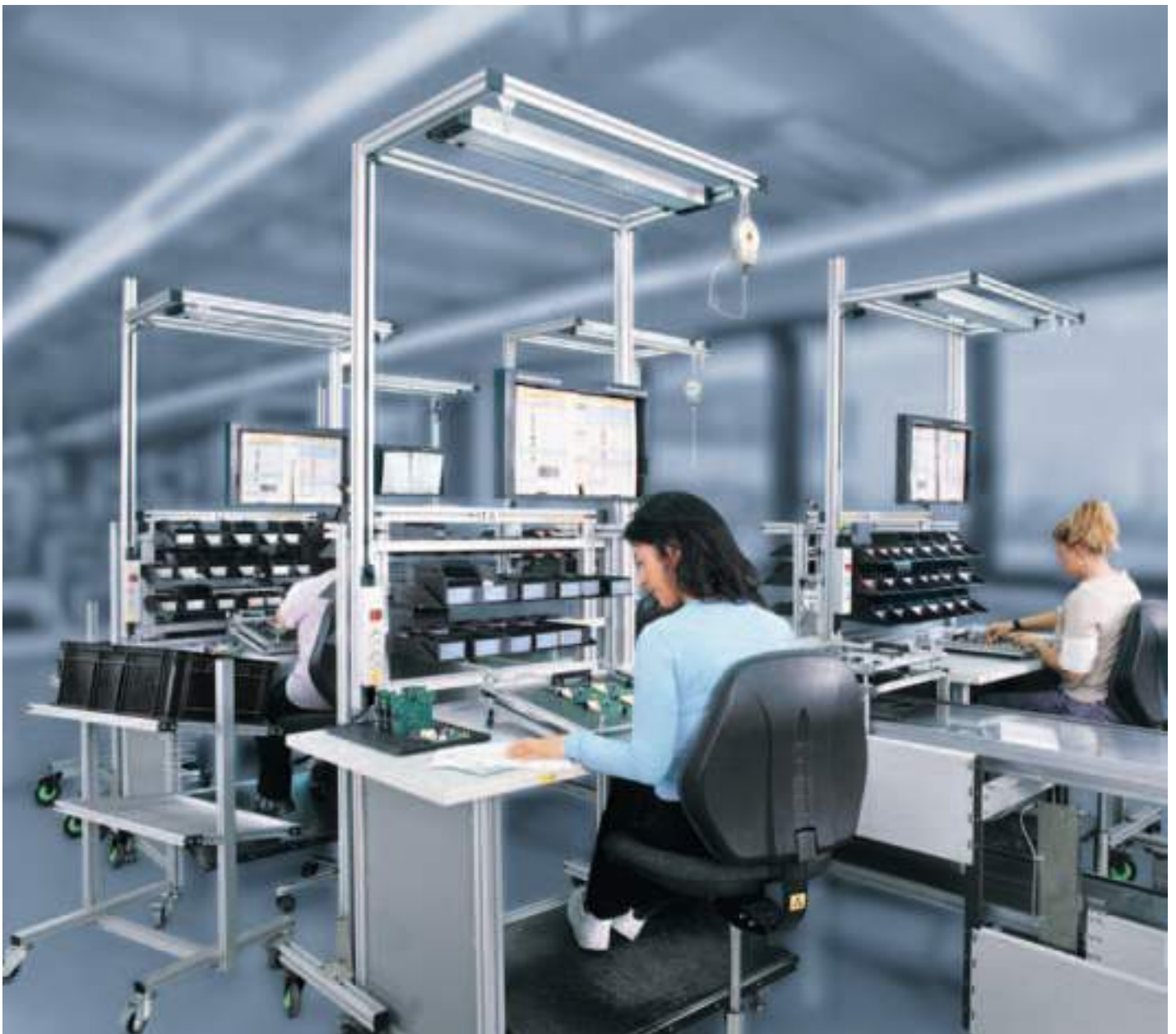
▲ Posti di lavoro ESD nella produzione di circuiti stampati Puestos de trabajo ESD en la producción de circuitos impresos Postos de trabalho ESD na produção de placas de circuito impresso Honeywell AG, Schönaich, D Made by UTZ Ratio Technik GmbH, Korb, D
