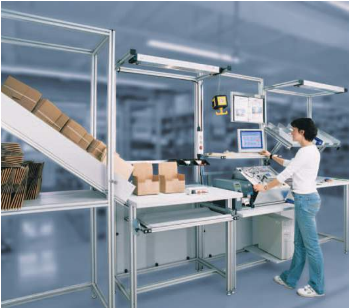
▲ Banco d'imballaggio con collaudo finale per centraline di comando Mesa para embalar con control final para unidades de control Mesa de embalagem com controle final para dispositivos de comando Honeywell AG, Schönaich, D Made by UTZ Ratio Technik GmbH, Korb, D
